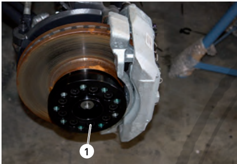
Abb. 6.1 Adapterring für Alufelgen demontieren
