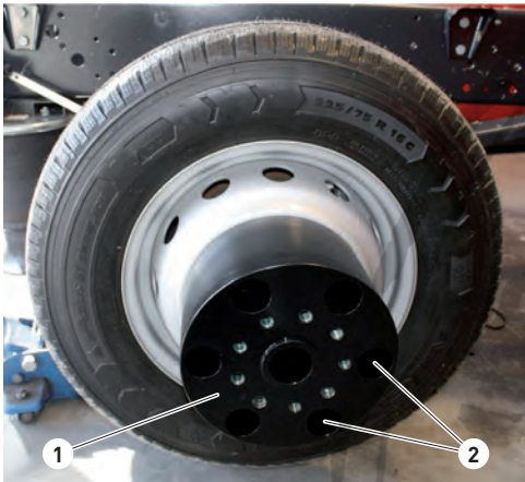
Abb. 6.6 Adapter für Alufelge demontieren
