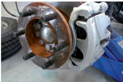
Abb. 6.5 Stahlfelgenaufnahme mit Spurverbreiterung montiert
