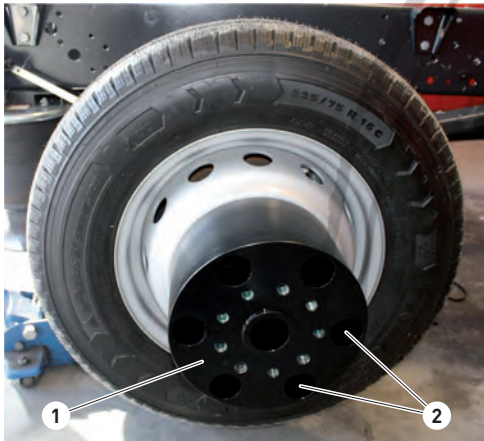
Abb. 6.7 Adapter für Alufelge demontieren
