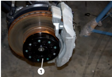
Abb. 6.3 Adapterring für Alufelgen demontieren
