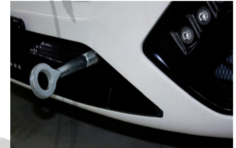
Abb. 6.9 Anhängeöse in Aufnahme einschrauben
